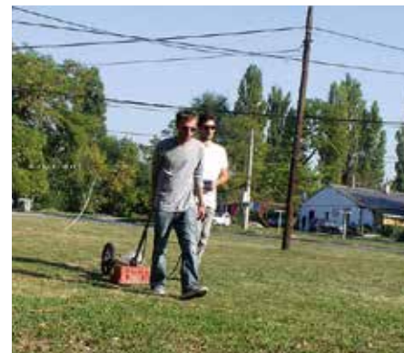
илл. 2. Исследование при помощи георадара (д-р Кэролайн Старди Коллс)
