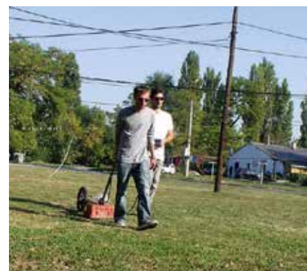
2 pav. Tyrimas georadaru (Caroline Sturdy Colls nuotr.)
